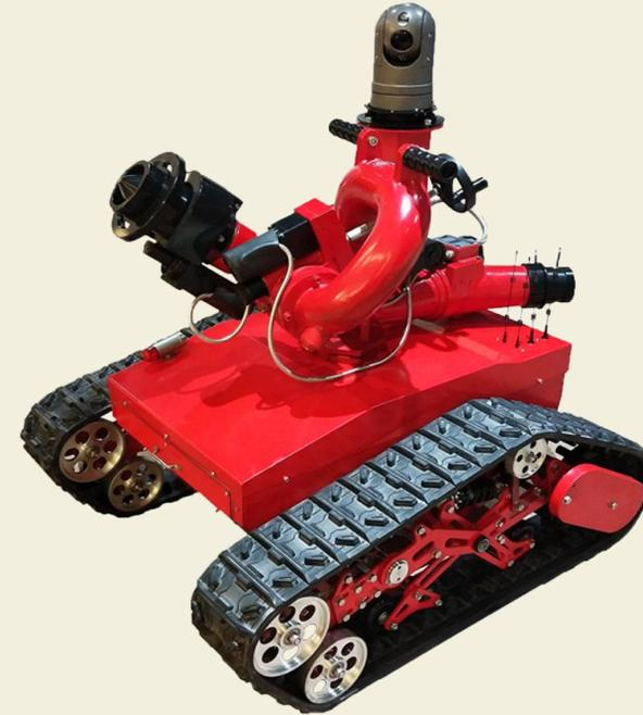
消防灭火机器人是一款履带式全地形移动灭火机器人，整体结构由底盘、遥控器、液控炮和电液控制系统等组成，操作人员通过遥控器控制车体行走，作为高科技产品的消防灭火机器人，能对各种灭火场合提供崭新的消防灭火技战术手段。
